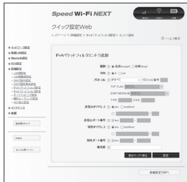
(画面は IPv4 パケットフィルタエントリ追加画面です)
